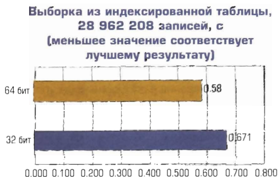
Рис. 4. Результаты тестирования. Производительность выборки в рабочем режиме
